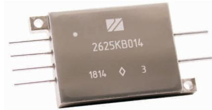
Микросборки изготовлены в соответствии с ОСТ В 11 1009 по гибридной технологии, с оптоэлектронной гальванической развязкой, схемой управления с контролем перехода фазы коммутируемого напряжения через "ноль" и выходным каскадом на тиристорах с RC - цепью ограничения напряжения при переходных процессах.
