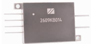
Микросборки изготовлены по гибридной технологии в соответствии с ОСТ В 11 1009, с оптоэлектронной гальванической развязкой, схемой управления и выходным каскадом на МОП-транзисторах.
