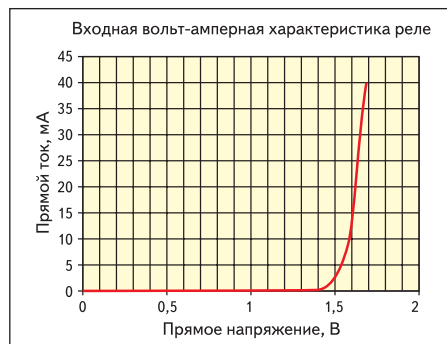
Рис. 1г. Входная характеристика реле постоянного тока типа 5П40
