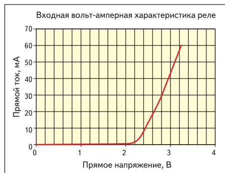
Рис. 1а. Входная ВАХ реле переменного тока 6-го и 8-го классов для реле с коммутацией при переходе через «0» и 6-го класса для реле с коммутацией в произвольной фазе коммутируемого напряжения
