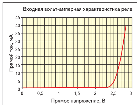
Рис. 1в. Входная ВАХ реле постоянного тока типа 5П20
