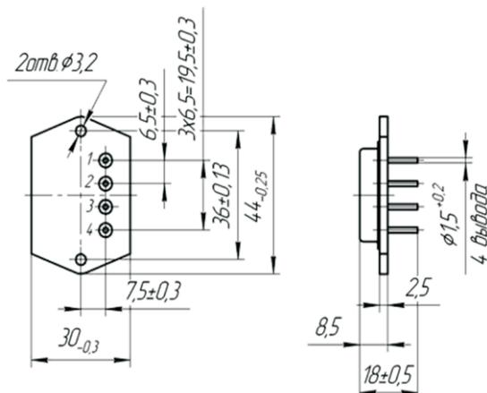
Одноканальный нормально замкнутый полупроводниковый ключ для коммутации цепей постоянного тока величиной до 10 А напряжением до 100 В для применения в аппаратуре специального назначения.
