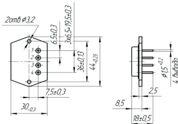
Одноканальный нормально разомкнутый полупроводниковый ключ для коммутации цепей постоянного тока величиной до 10 А напряжением до 400 В для применения в аппаратуре специального назначения
